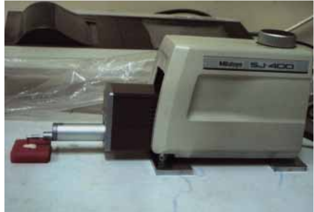
Fig 2 Mitutoyo SJ 400 Profilometer
